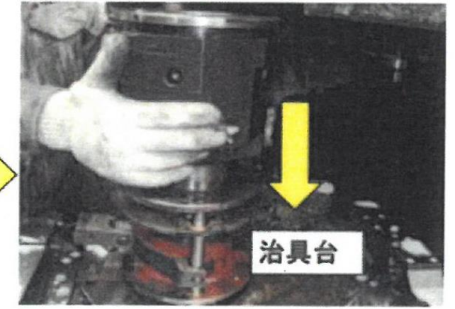
手で持ち上げ、高さ約140cmの 治具台へセットする
