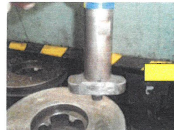
専用吊り具を製作
